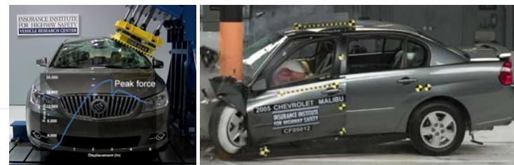
ルーフ圧壊試験、新オフセット試験案(出典 IIHS)
