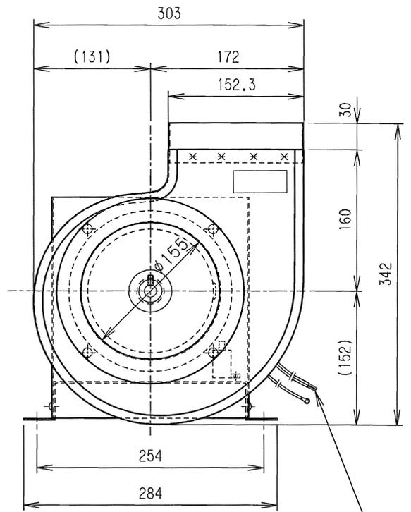
リード線長さ300mm(先端むき10mm)
