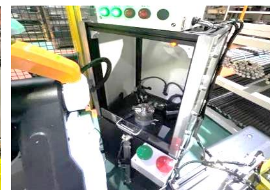
ハブ清掃工程作業
